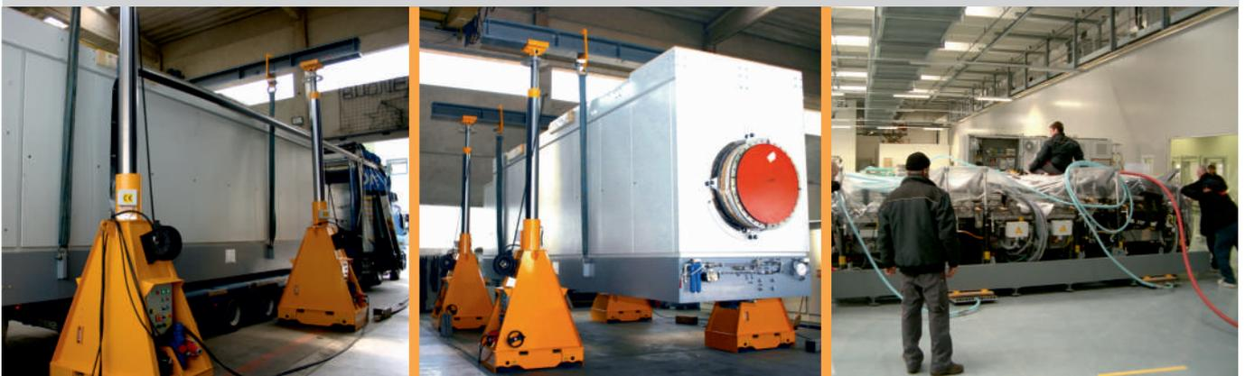
Movimentazione e posizionamento macchinari fino a 120 TON con attrezzature speciali in ambienti chiusi con minimi spazi di lavoro: cuscini ad aria (particolarmente adatti su pavimenti delicati), cavallette idrauliche, carri armati e crick idraulici.
